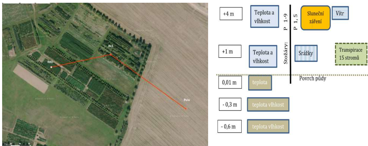
Obr. 3.1-1. Stanoviště monitorované v rámci KMS Michovky: ALS1 (stožáry P1-4), Pole (stožár P5 s 3 půdními čidly) a výmladková plantáž RRD (stožáry P6-9) a schéma stožárů s čidly (vpravo)
